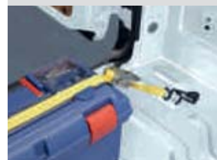
Грузовые петли, соответствующие стандартам DIN 75410 (Стандарт)
