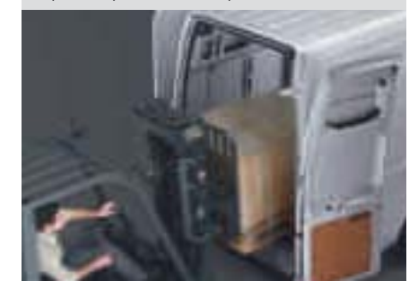
Незастекленные задние двери Двери, открывающиеся на 180°. (Стандарт*), открывающиеся на 256°. (Стандарт на 'Jumbo'**)
