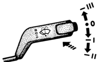
Рис. 5.4. Положение рычага переключателя стеклоочистителя и стеклоомывателя (без звукового сигнала)
