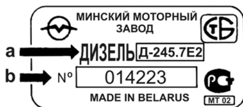
Рис. 1.2. Пример нанесения номера двигателя Д – 245.7 Е2
